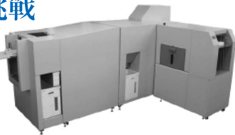
小型製紙装置 RECOTio Paper Maker PMI-1000
